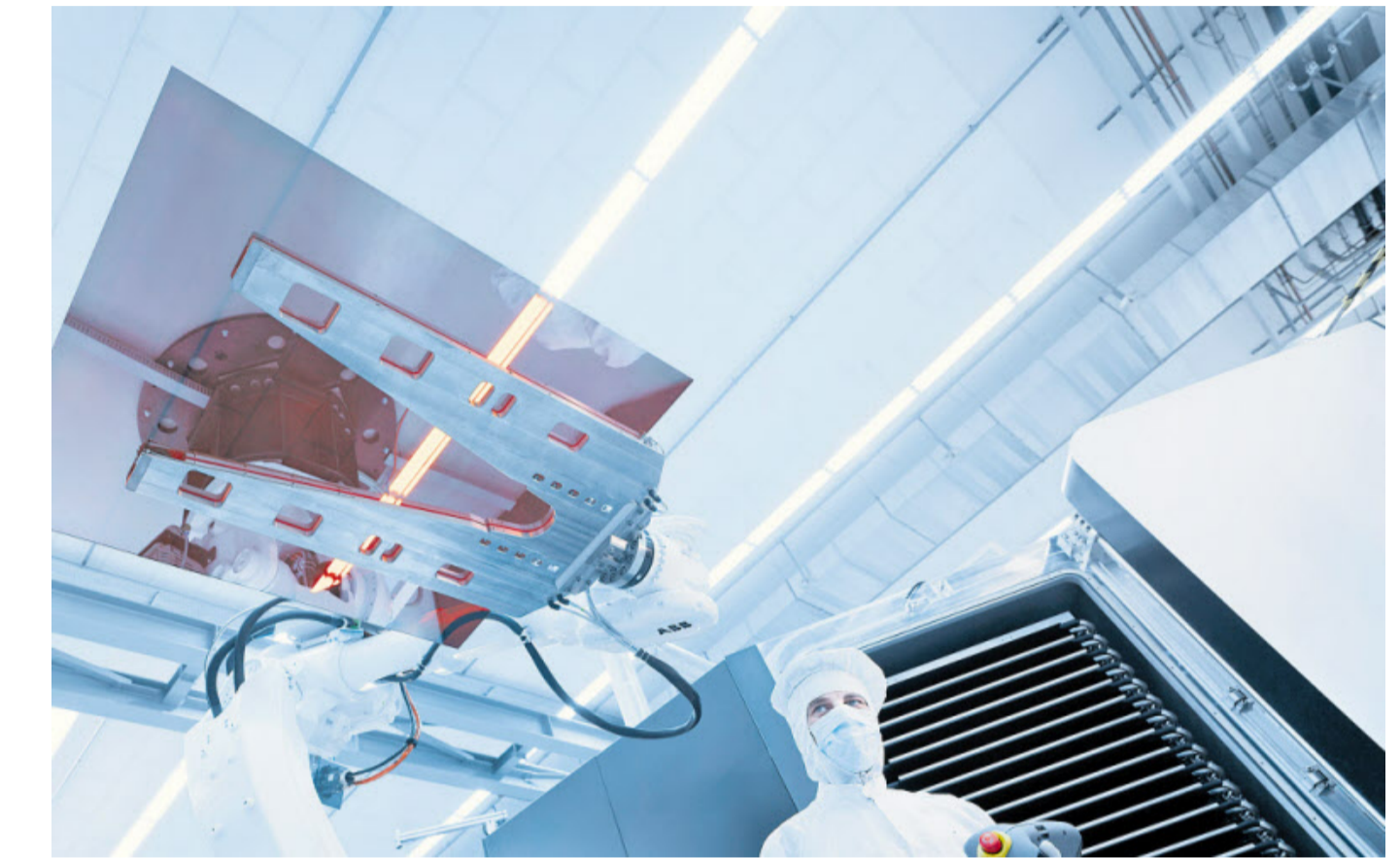
Ein Roboter entlädt die mit einer dünnen Siliziumschicht versehenen Glasplatten aus der Beschichtungsanlage.
